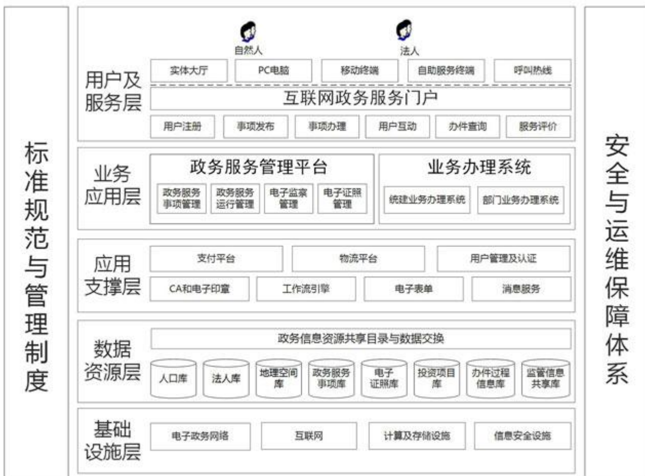
图 3-7 “互联网+政务服务”平台技术架构图
