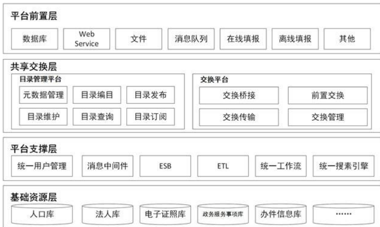
图 6-2 统一数据交换平台架构图
